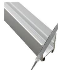
Para realizar figuras como marcos o ángulos a 90°, haga los cortes diagonales, para que, al unir los dos tramos de perfil de aluminio, se forme la figura deseada sin sombras ni obstáculos en el luminario terminado. Puede hacer cortes diagonales para que el luminario tenga luz frontal, interna o externa.
